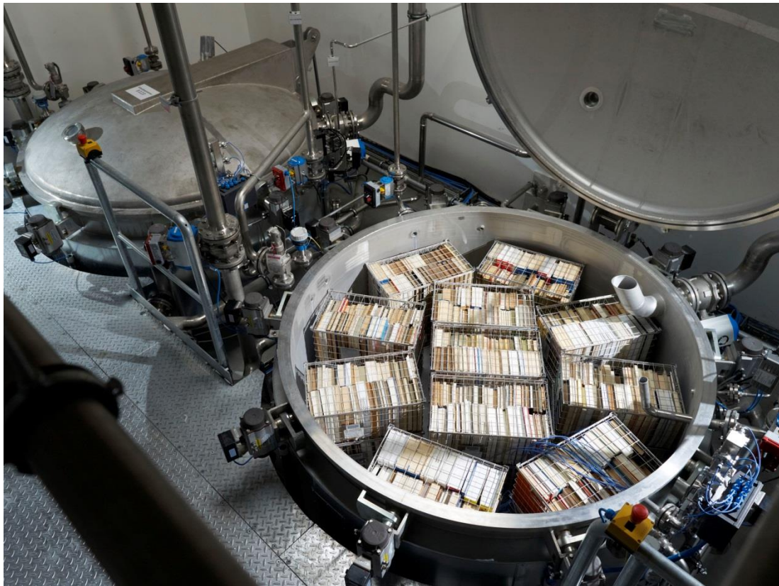
Entsäuerungsanlage des „Zentrums für Bucherhaltung“ (ZFB) in Leipzig (Foto: Birgitta Kowsky)
